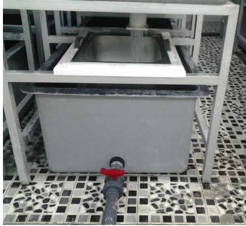
شكل (5) يوضح الحاوية المصممة لحمل المرشح الميكانيكي
