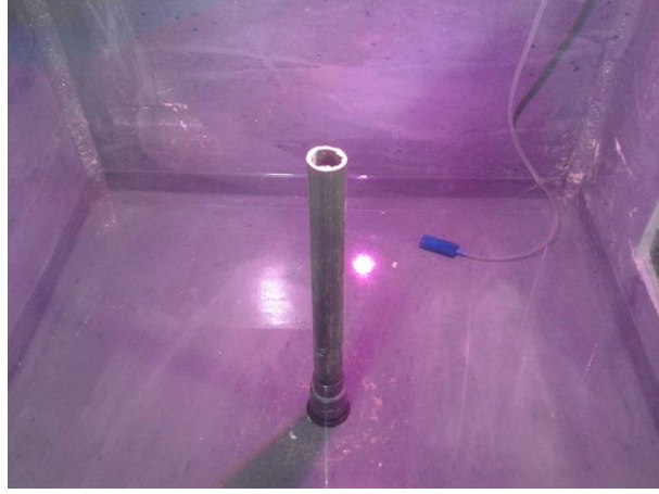
شكل (2) يوضح الأنبوب القائم المركزي للتخلص من الفضلات الصلبة وتجديد المياه.
