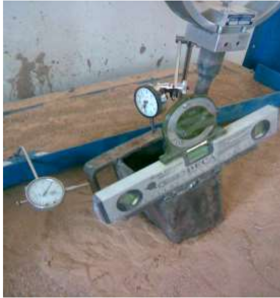
صورة (٢) شكل فشل التربة تحت الأساس
