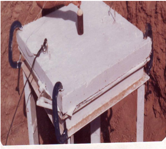
شكل (2): هيكل فحص العصف الحقلي مع شحنة الاختبار قبل وبعد التفجير للنموذج PL-10
