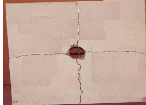
شكل (5) التشققات ومساحة التدمير لوجهي الألواح PL-16 و PL-15 المعرضة لموجات عصف وعلى التوالي
