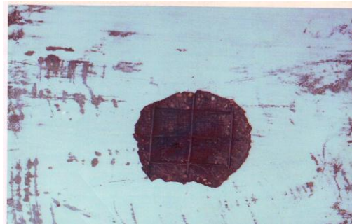
شكل (6): التطاير والتفشر والتشقق لوجهي الألواح PL-17 و PL-19 المعرضة لقوى صدم ذات السرعة الواطئة (كرة حديدية ساقطة)
