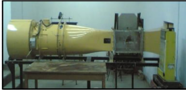
شكل (5) جهاز نفق الهواء المستخدم في التجارب المختبرية
