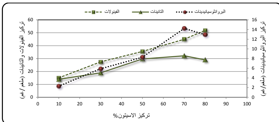
الشكل(9):تأثير تركيز الاسيتون في استخلاص الفينولات الكلية والتانينات والبروانثوسيانيدينات من بذور العنب
