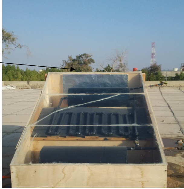
الشكل (٣) صورة فوتوغرافية توضح العاكس (الألمنيوم الحراري) داخل السخان الشمسي المركب
