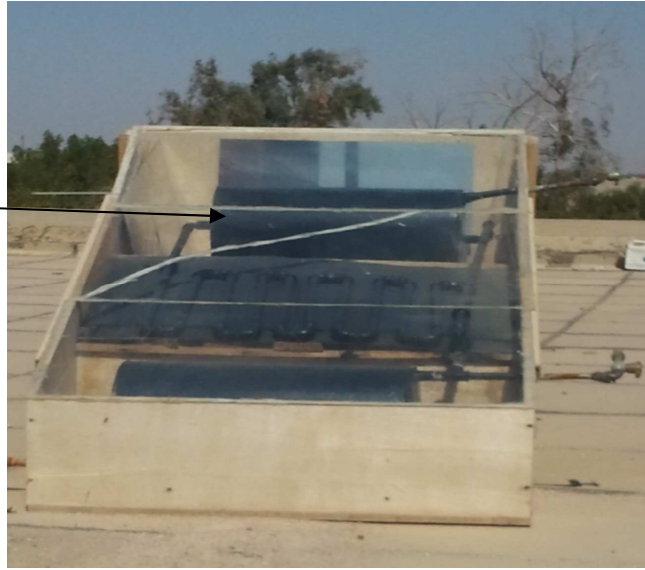
الشكل (٤) صورة فوتوغرافية توضح العاكس (المرايا) داخل السخان الشمسي المركب
